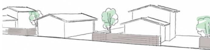
敷地境界ギリギリまでブロック堀や建物が来ると、道に対して圧迫感を与えます。また、ブロック堀は老朽化や地震による倒壊の危険が考えられるため、新設は極力控え、既存のブロック堀でひび割れなど倒壊の兆候があるものはできるだけ撤去していきましょう。
