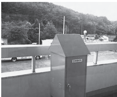
写真1 コミュニティセンターに設置されている粉じん捕集装置
